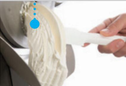
Die Konsistenz wird durch Messung des Drehmoments des Rührwerks in Newtonmeter, der Temperatur des Kühlgases und der des Eises im Zylinder kontrolliert. Diese technologische Lösung sorgt dafür, dass unabhängig vom Rezept immer die gewünschte Konsistenz erzielt wird.
