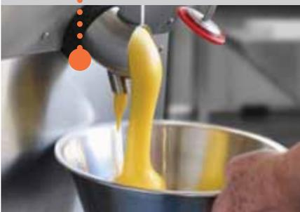
Aus nahtlosem Monoblock-Stahl gewährleistet er ein perfektes Ausgießen der Zubereitungen. Mit Doppelsicherung. Mit dem variablen Durchmesser werden flüssige Mischungen und bei Temperaturen von +4°C besonders dickflüssige Cremes praktisch und schnell ausgegossen. Nach jeder Entnahme wird das Produkt sofort in die Wanne geleitet und dort hygienisch und kühl gelagert.
