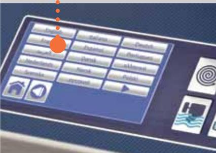
Mit dem neuen Sprachsystem von Valmar kann man eine der vielen gespeicherten Sprachen auswählen. Die auf dem Touchscreen angezeigten Softwaremeldungen in der jeweiligen Sprache unterstützen den Bediener während der Zubereitung. Auf dem Monitor werden die vom gewählten Programm vorgesehenen Arbeitsgänge Schritt für Schritt beschrieben.
