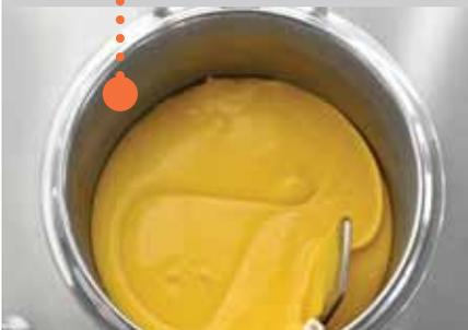
Kühlung und Kältespeicherung mit dem Wasserbadsystem der neuesten Generation, das gleichbleibende und kontrollierte Temperaturen ohne thermische Trägheit gewährleistet. Ein spezifisches System vermeidet die Vereisung bei der Zubereitung kleiner Mengen und während der Kältespeicherung. Das Kontrollsystem zeigt Stromausfälle während der Kältespeicherung an.
