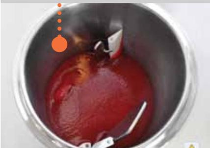
Mit einem eigens dafür ausgelegten Programm steuert und kontrolliert Chef Cream TTi die vom verarbeiteten Produkt abhängige Temperaturprogression und Aufheizgeschwindigkeit. Auf diese Weise wird das durch zu schnelle Erhitzung verursachte Überkochen vermieden und die zubereitbare Höchstmenge dieser Produkte erhöht.
