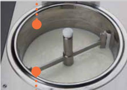
Durch das Verhältnis zwischen Durchmesser und Tiefe haben wir einen "technologischen Topf" mit einem weiten Boden erhalten. Dieser optimiert den Wärmeaustausch, ohne dass das Produkt anbrennt oder misslingt. Das Rührwerk ist mit einem patentierten Gegen-Rührwerk ausgestattet und lässt sich schnell und einfach abmontieren. Gleichmäßiges Schabersystem auf der gesamten Zylinderfläche, das schnell und einfach abgenommen und gewaschen werden kann.
