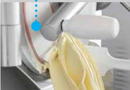
Man kann die automatische Entleerung des Eises durch die automatische Geschwindigkeitsveränderung des Rührwerks auswählen. Das Eis bleibt während des ganzen Vorgangs trocken. Die progressive Geschwindigkeitsveränderung kann individuell bestimmt werden, dies ist besonders beim Entleeren von Eiscreme mit marmoriertem Effekt praktisch.
