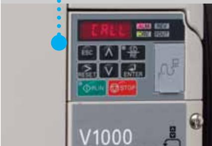
Verändert die Drehgeschwindigkeit des Rührwerks von 5 bis 70 Hertz. Mit Hilfe der SPS und des Wechselrichters werden zahlreiche Zubereitungen, vor allem die Eisbereitung entsprechend den Eigenschaften von Mischung, Zutaten und Abgewogenheit sowie der hergestellten Menge möglich und man erhält optimale Endergebnisse. Absolut neu ist die Möglichkeit die automatische Entleerung der Eiscreme auszuwählen. Dadurch bleibt das Eis während des gesamten Vorgangs trocken.
