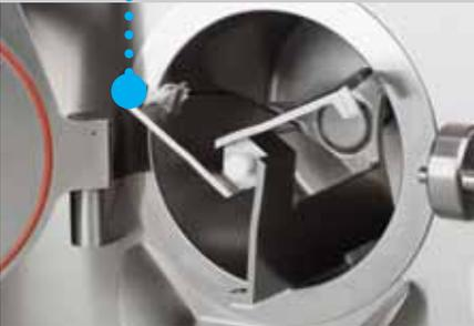
Der Zylinder ist so geformt und getestet, dass das Verhältnis zwischen Durchmesser und Tiefe die perfekte Kombination der Kühlleistung, Kühlgeschwindigkeit, Mikrokristallisierung und der optimalen Luftuntermischung gewährleistet.
