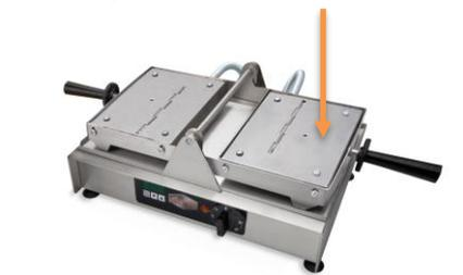
1. Legen Sie die Backplatten geschlossen auf eine Seite des geöffneten Waffeleisens.
