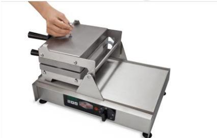
3. Nehmen Sie beide Griffe und klappen Sie den Backplattensatz geschlossen auf die andere Seite. Vorsicht! Halten Sie die Backplatten bei diesem Vorgang fest verschlossen, da eine Backplatte noch gelöst ist. Fixieren Sie ebenfalls die Schraube auf der jetzt oben liegenden Backplatte.
