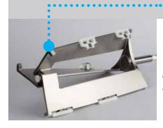
Die besondere Form des spiralförmigen Rührwerks mit variabler Konvergenz und die leistungsfähigen Schaber sind nur einige Charakteristiken, die das neue Rührwerk der Serie TTi auszeichnen. Durch das systematische und gleichmäßige Rühren der Eiscreme auf der gesamten Zylinderoberfläche, wodurch vermieden wird, dass das Eis auf den Blättern oder in der Zylindermitte (Kreuzeffekt) übermäßig gefriert, erhält man eine perfekte Eiscreme.
