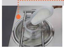
Der doppelte Deckel mit durch hydraulische Kolben unterstütztem Servo-Öffnungsmechanismus ermöglicht es, die Zutaten auch bei schon begonnener Verarbeitung problemlos hinzuzufügen, ohne die Maschine auszuschalten. Das Ganze entspricht den EG-zertifizierten Sicherheitsnormen.
