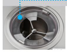
Das Volumen des Zylinders ist in wohlüberlegter Weise so zwischen Durchmesser und Tiefe aufgeteilt, dass die perfekte Kombination von Kühlleistung, Kühlgeschwindigkeit, Mikrokristallisierung des Wassers sowie die optimale Luftuntermischung gewährleistet wird.
