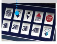
Eine absolute Neuheit ist das Entleeren des Eises durch die automatische Veränderung der Drehgeschwindigkeit des Rührwerks. Diese ändert sich automatisch in progressiver Weise, weshalb das Eis von Beginn des Entleerungsvorgangs bis zu dessen Ende trocken bleibt. Die Geschwindigkeitsveränderung kann individuell bestimmt werden. Vor allem beim Entleeren von Eiscreme mit marmoriertem Effekt ist die Tatsache, dass die Hände frei sind und keine Schalter betätigt werden müssen, besonders praktisch.
