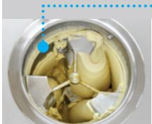
Unabhängig von der Geschwindigkeit bleibt die Drehrichtung des Rührwerks immer die gleiche. Dadurch ist die Mechanik der Maschine auf die Dauer wesentlich zuverlässiger.
