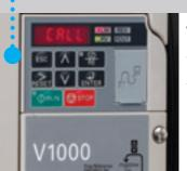
Verändert die Drehgeschwindigkeit des Rührwerks von 7 bis 70 Hertz. Mit Hilfe der SPS gewährleistet der Wechselrichter auch bei besonders empfindlichen Zubereitungen die ideale Drehgeschwindigkeit bezüglich der Menge und Eigenschaft der Mischung, den Zutaten und dem Verhältnis derselben.
