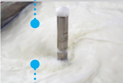
Erhitzt wird im Wasserbad, wobei die Flüssigkeit ständig umgerührt wird. Dies gewährleistet zusammen mit der Steuerung der Heizwiderstände über SPS gleichbleibende und präzise Temperaturen, vor allem wenn mit 30% der Produktionsleistung gearbeitet wird, ohne dass die Mischung oder die Wände der Maschine anbrennen.
