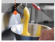
Aus nahtlosem Monoblock-Stahl gewährleistet er ein perfektes Ausgießen der Zubereitungen. Mit Doppelsicherung. Mit dem variablen Durchmesser werden flüssige Mischungen und bei Temperaturen von +4°C besonders dickflüssige Cremes praktisch und schnell ausgegossen. Nach jeder Entnahme wird das Produkt sofort in die Wanne geleitet und dort hygienisch und kühl gelagert.
