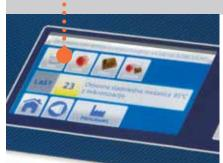
Mit der neuen PLC-Steuerung (Programmable Logic Controller) werden die zahllosen Programme des Chef Cream TTi, von denen viele individuell programmiert werden können, ausgeführt. Auf dem praktischen und weiten LCD-Bildschirm werden die jeweils für den bestimmten Arbeitsgang notwendigen Tätigkeiten beschrieben.
