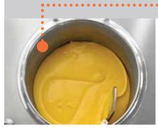
Kühlung und Kältespeicherung mit dem Wasserbadsystem der neuesten Generation, das gleichbleibende und kontrollierte Temperaturen ohne thermische Trägheit gewährleistet. Ein spezifisches System vermeidet die Vereisung bei der Zubereitung kleiner Mengen und während der Kältespeicherung. Das Kontrollsystem zeigt Stromausfälle während der Kältespeicherung an.
